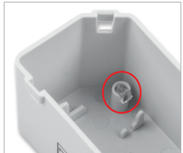
Bild 12: So erfolgt das Einsetzen des Lichtleiters in das Gehäuseoberteil.
