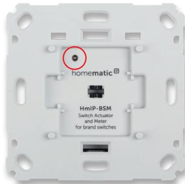
Bild 11: Nach dem Zusammenbau des Gehäuses ist mit einem spitzen Gegenstand die Beweglichkeit des Tasterstößels zu testen.
