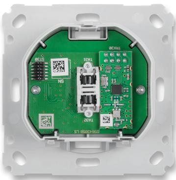
Bild 7: Bereits in das Gehäuse eingebaute Controllerplatine
