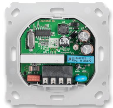
Bild 9: Die Leistungsplatine wird mit der Buchsenleiste in die Stiftleiste der Controllerplatine eingesetzt ...
