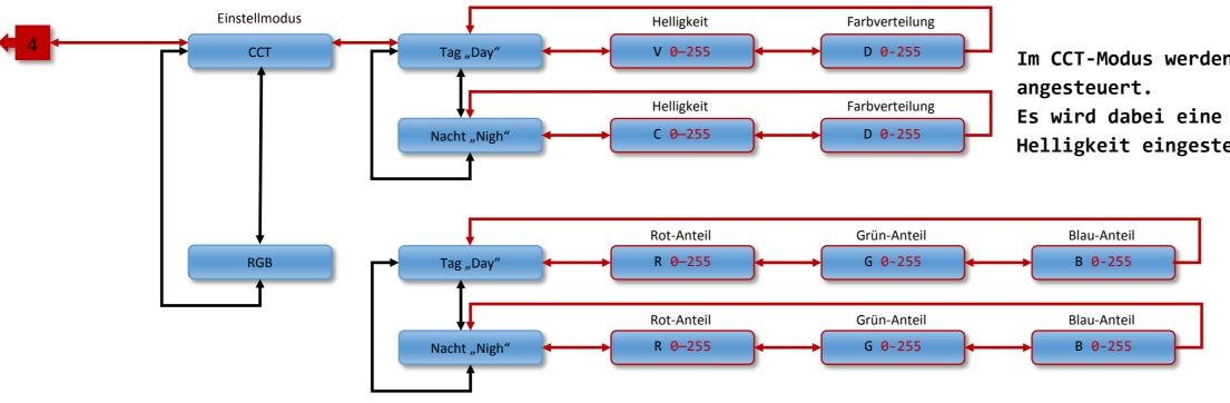
Im CCT-Modus werden nur die Kanäle R und B bzw. WW, KW angesteuert.
