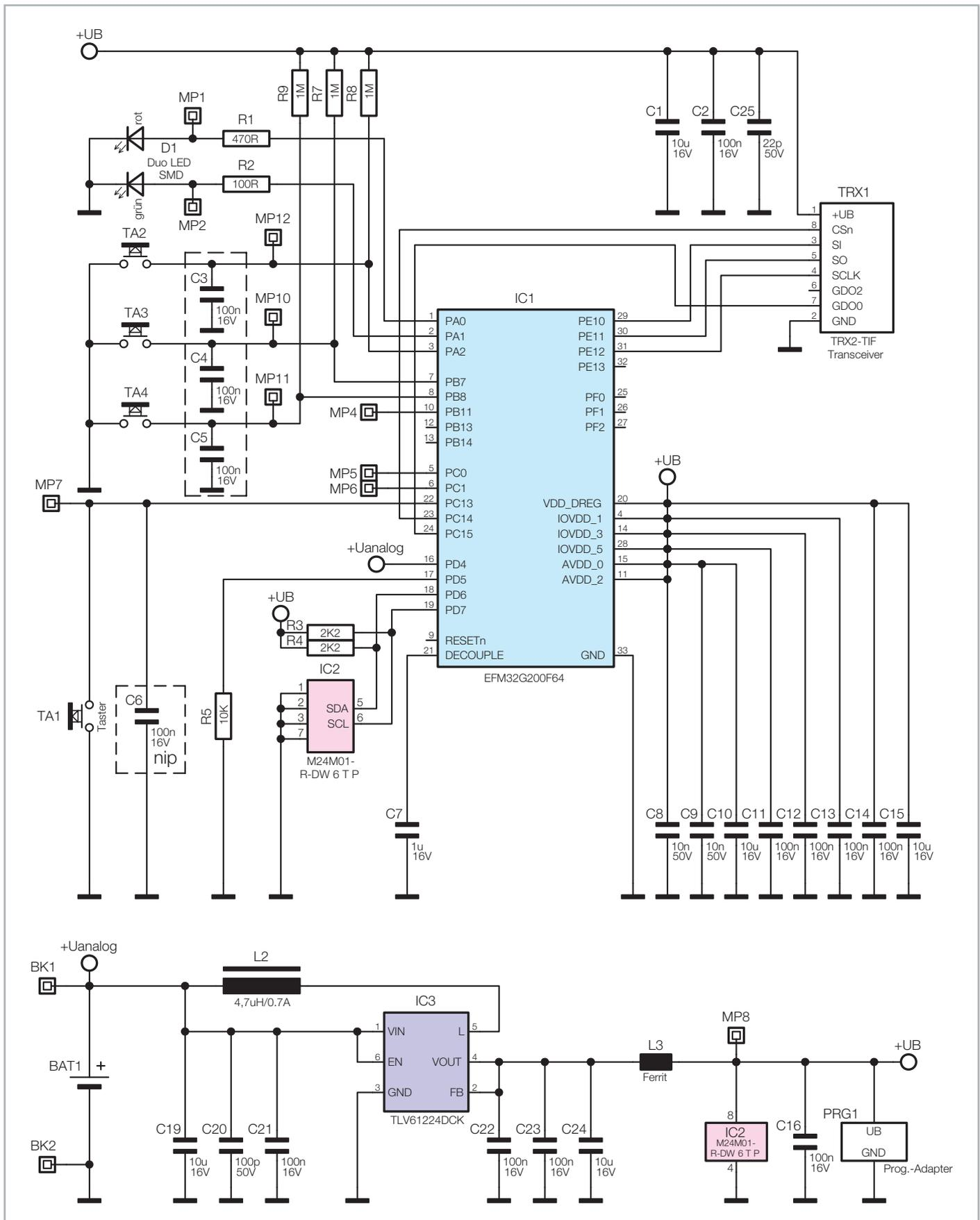
Bild 2: Das Schaltbild des Fenstergriffsensors HmIP-SRH
