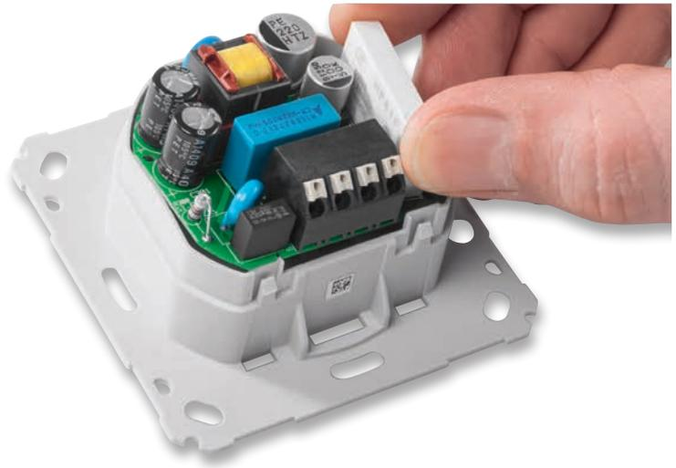
Bild 22: So wird die Netzteilplatine eingesetzt. Die Markierungen zeigen zwei der drei Rasten für das folgende Verrasten des Gehäuseunterteils. Die dritte Raste befindet sich auf der gegenüberliegenden Seite.
