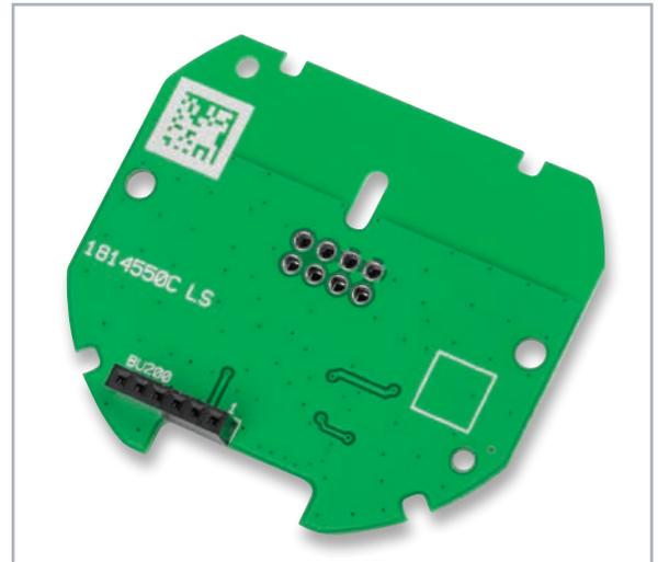
Bild 10: Die Treiberplatine mit der bestückten Buchsenleiste BU200
