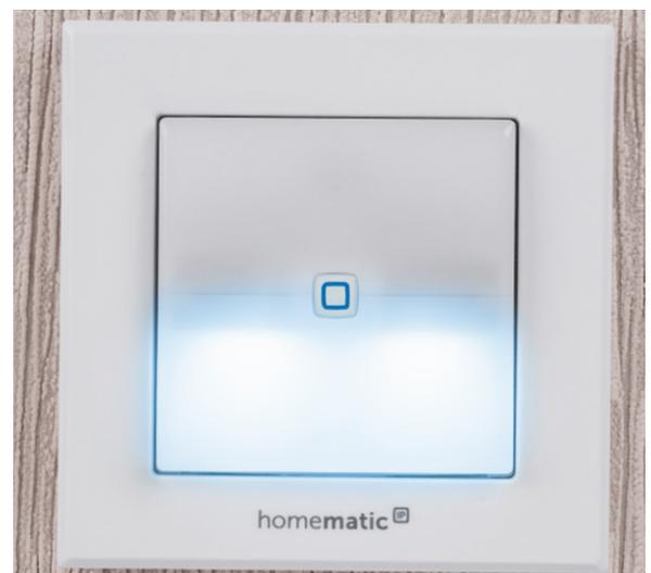
Bild 28: Das fertig installierte Gerät, hier in der Anwendung als Nacht-/Orientierungsleuchte
