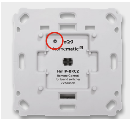
Bild 13: Der Tasterstößel ist auf Leichtigkeit zu prüfen.
