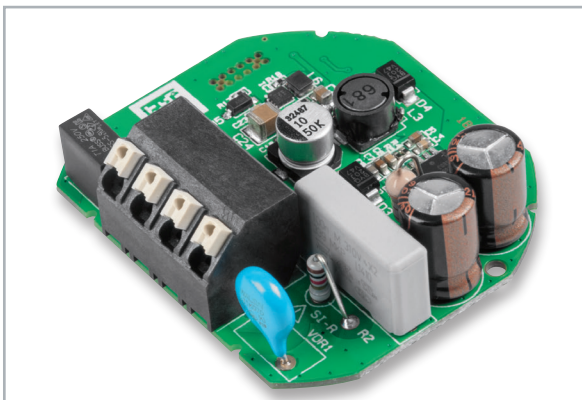
Bild 5: Hier sind die exakt bestückten bedrahteten Bauteile der Stromversorgungsplatine zu sehen.
