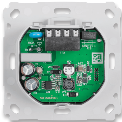
Bild 11: Die eingelegte und aufgesteckte Stromversorgungsplatine
