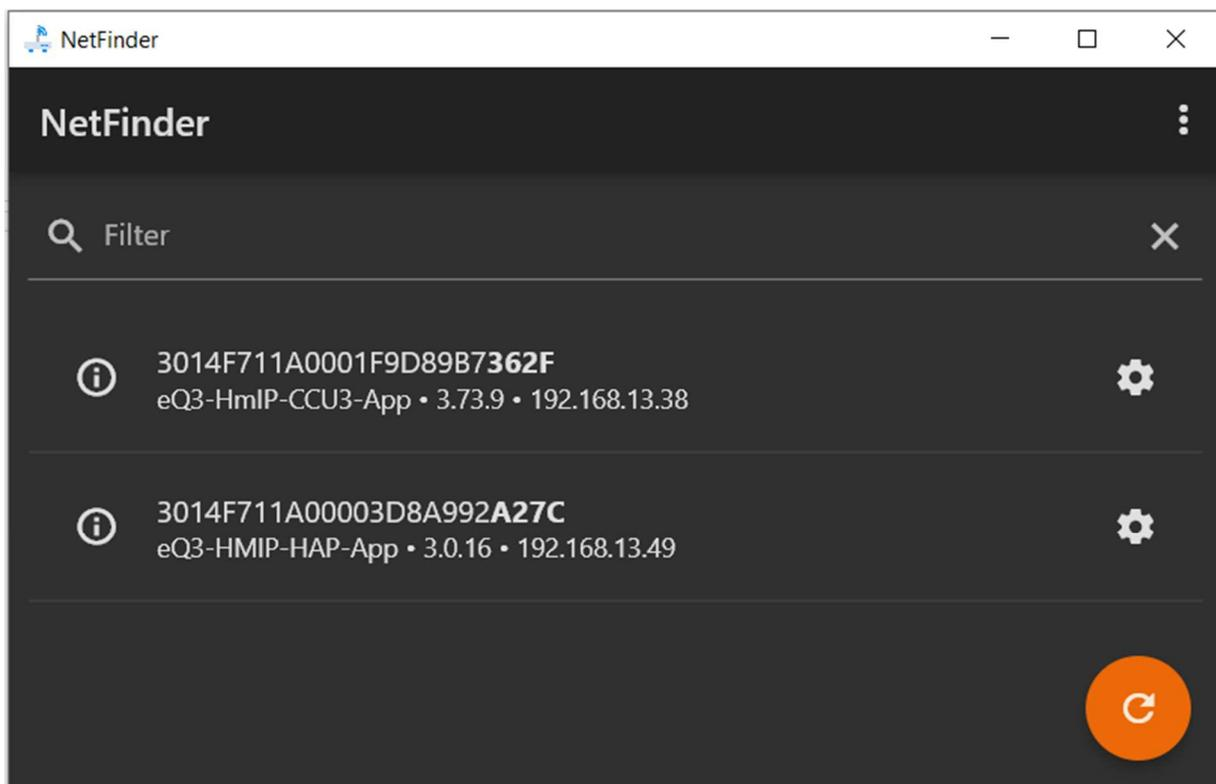
Es werden die im Netzwerk gefundenen Homematic-Komponenten angezeigt. In diesem Beispiel sind es die Homematic-Zentrale CCU3 und der Homematic IP Access Point HmIP-HAP.
