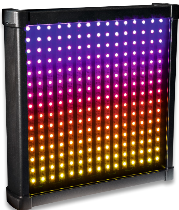
Bild 13: Hier sind LEDs in einer 15x15-Matrix angeordnet.
