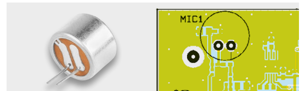
Bild 9: An der Elektret-Mikrofonkapsel sind die seitlich versetzten Anschlüsse gut zu erkennen. Die Mikrofonkapsel ist genau übereinstimmend mit der Markierung auf der Platine zu bestücken.
