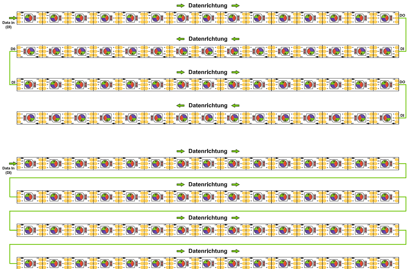
Bild 14: Anordnung der LEDs in Mäanderform (oben) und in „normaler“ Anordnung (unten)
