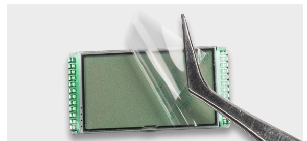
Bild 11: So erfolgt das Abziehen der Display-Schutzfolie.
