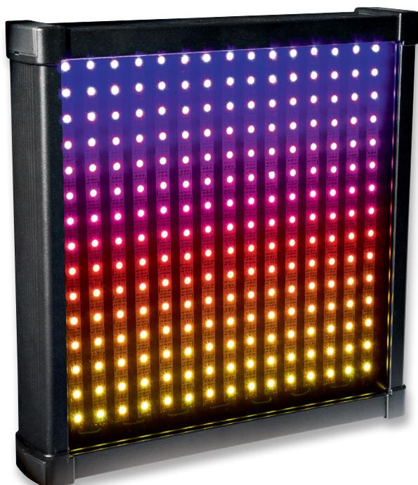
Bild 13: Hier sind LEDs in einer 15x15-Matrix angeordnet.
