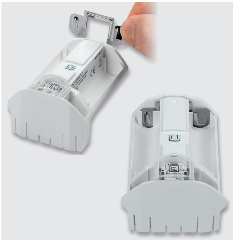
Bild 17: Das Einsetzen des gegenüberliegenden Batteriekontakts: Eindrücken, bis er sicher verrastet ist.
