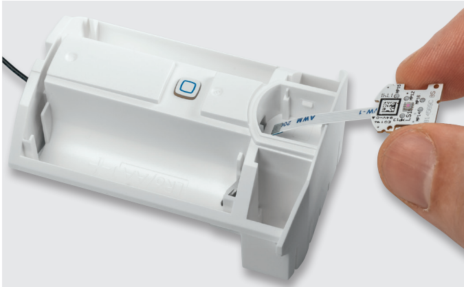
Bild 12: So wird das Flachbandkabel in das Gehäuse geführt ...
