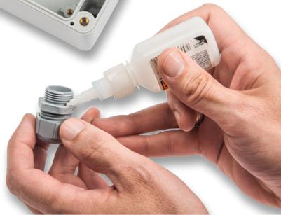
Bild 18: Zur besseren Fixierung sind die Verschraubungen – wie hier gezeigt – vor dem Einsetzen in das Gehäuse mit ein wenig Sekundenkleber zu versehen.
