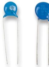
Bild 10: Nicht verwechseln – links ist C2 zu sehen, rechts VDR1.
