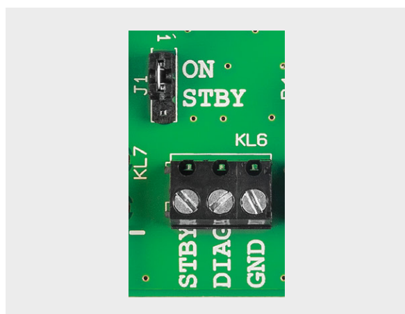
Bild 10: Jumper J1 und die externe Klemme KL6
