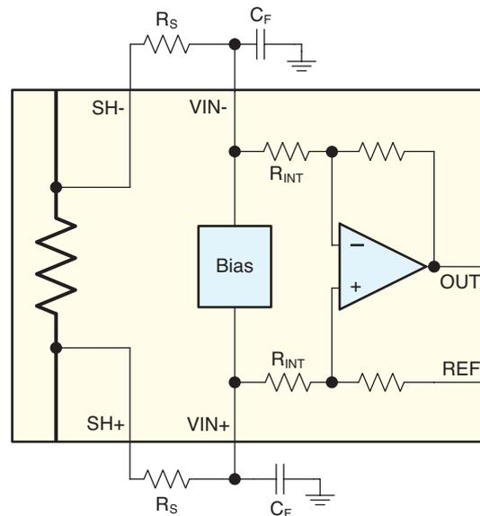
Da die Anschlüsse des Shunts bereits Chipintern auf den integrierten Verstärker geführt werden, haben parasitäre Einflüsse wie z. B. Übergangswiderstände keinen nennenswerten Einfluss auf das Messergebnis. Das „package resistance“, also von Anschluss zu Anschluss, ist mit 4,5 m $\Omega$  angegeben. Für die Messung sind aber nur die 2 m $\Omega$  des Shunts relevant.
