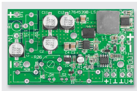
Bild 5: Platinenoberseite der Multilayer-Leiterplatte im Auslieferungszustand
