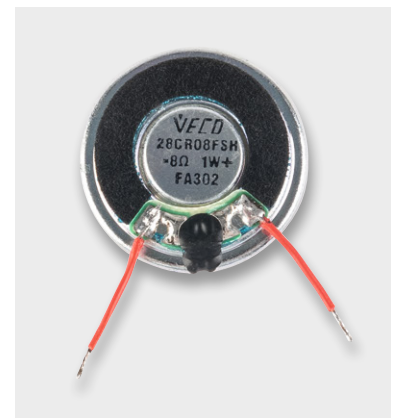
Bild 15: An den Lautsprecher werden die Verbindungsleitungen (4 cm) angelötet.
