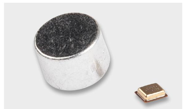
Bild 5: Direkter Vergleich zwischen einem Elektret- (links) und einem MEMS-Mikrofon (rechts)
