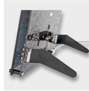
Bild 5: So werden die Aufstellbügel (Platinen) angelötet.
