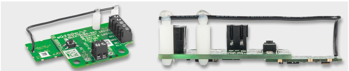
Bild 5: So wird die Sende-/Empfangsantenne verlegt und befestigt
