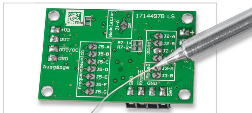
Bild 17: Das Aufbringen einer Kurzschlussbrücke mittels Auflöten
