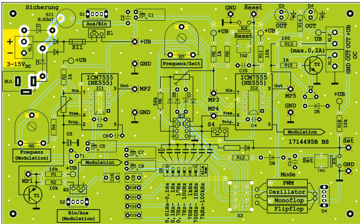
Bild 19: Platinenfoto und Bestückungsplan der Experimentierplatine NE555-EXB
