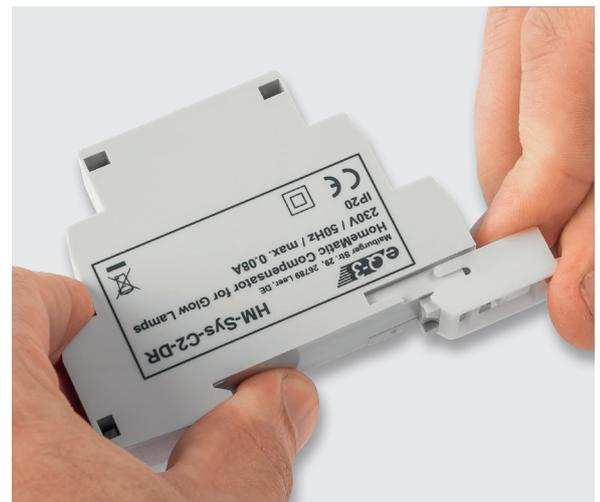
Bild 10: Zum Schluss erfolgt, wie hier gezeigt, das Aufsetzen des Rastschiebers.
