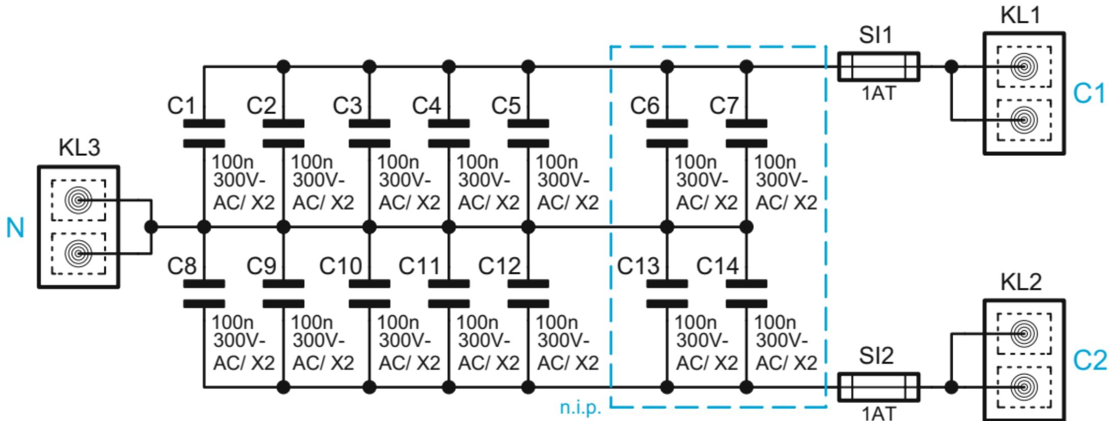
Bild 3: Das Schaltbild des Kompensators HM-Sys-C2-DR
