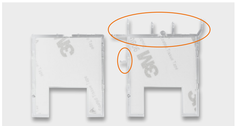
Bild 5: Der Displayrahmen – die abzutrennenden Teile sind hier im Bild rechts markiert, links der fertig vorbereitete Rahmen.
