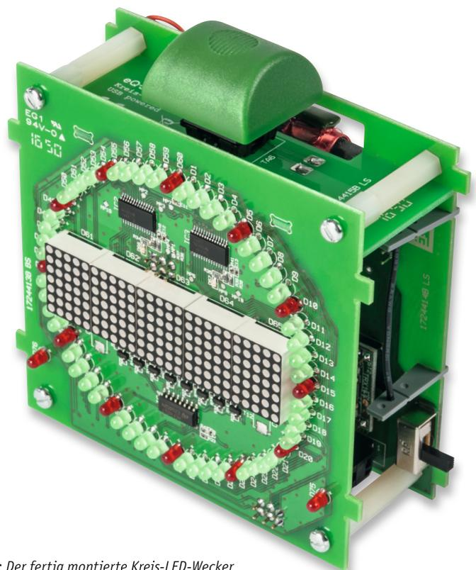
Bild 14: Der fertig montierte Kreis-LED-Wecker
