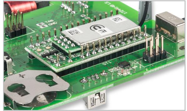
Bild 10: So ist das Homematic Modul einzusetzen.
