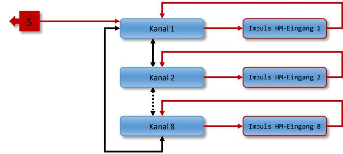
Je nach Auswahl des Kanals wird bei Betätigung von TA2 (Mode) ein kurzer Impuls auf den entsprechenden HM-Mod-EM-8 Eingang generiert.
