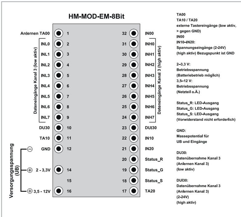
Bild 6: Die Belegung der Anschlüsse des Moduls
