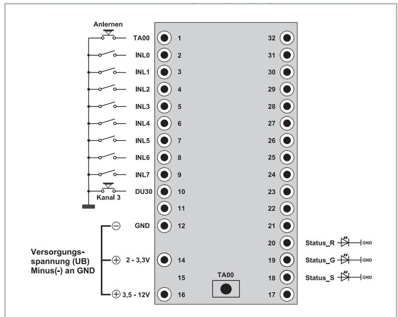
Bild 10: Anschluss zum Anlernen an Kanal 3
