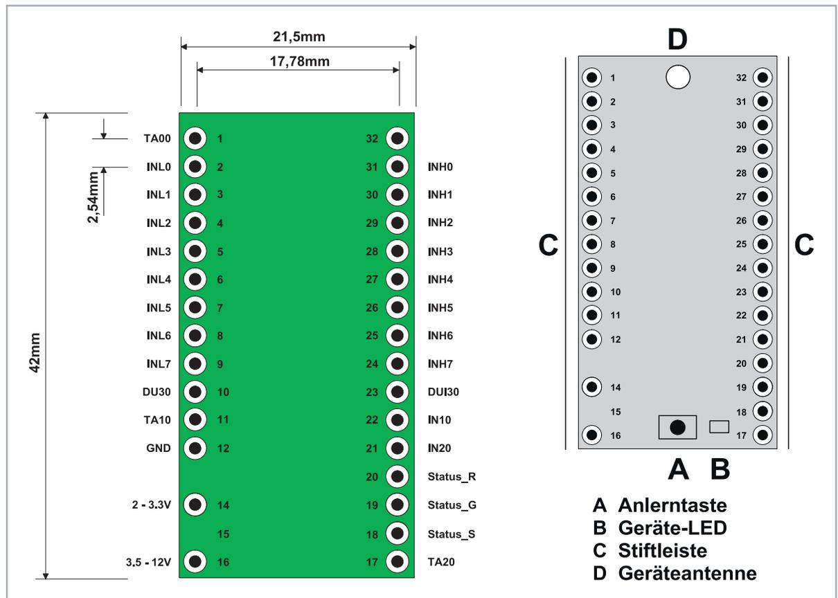
Bild 1: Die Maßskizze zeigt das Stiftraster und den Stiftrasterabstand des Moduls, rechts die Geräteübersicht.
