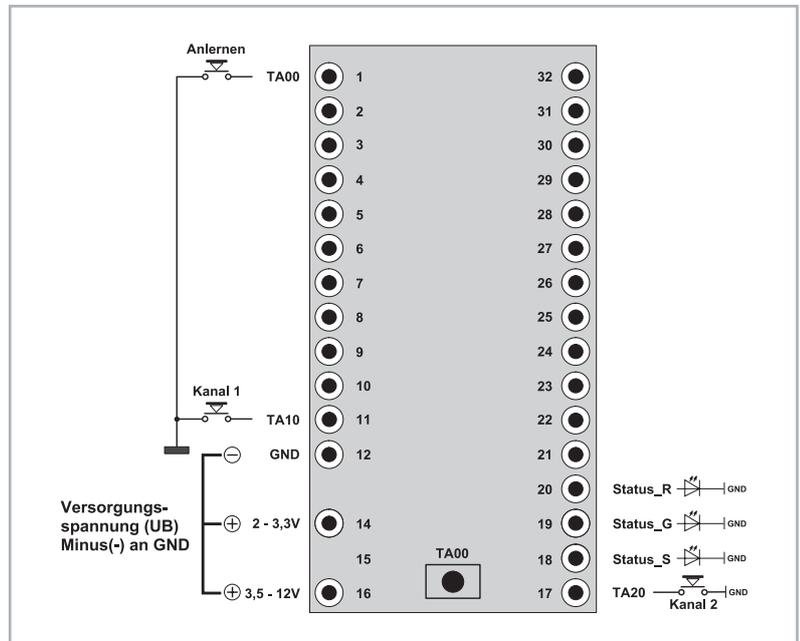
Bild 9: Anschluss zum Anlernen an Kanal 1 und 2
