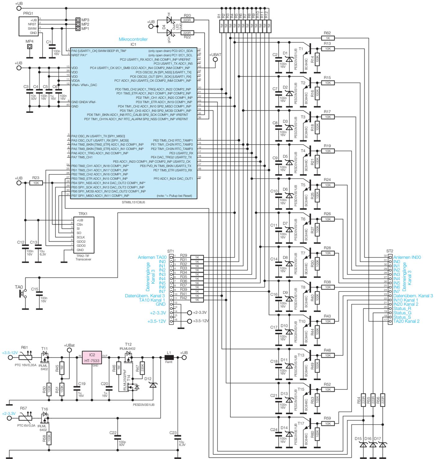
Bild 2: Das Schaltbild des Funk-Sendemoduls, 8 Bit
