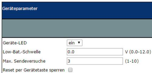
Bild 8: Bei Bedarf kann die Geräte-LED zur Signalisierung zugeschaltet werden. Hier ist auch das Aktivieren der Low-Bat-Meldung nach Eingabe eines Schwellwerts möglich.
