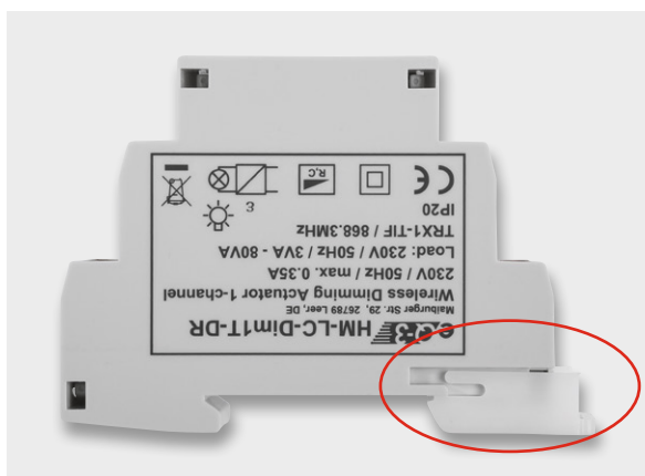
Bild 18: Letzter Montageschritt ist das Einschieben des Rastschiebers, der dem Fixieren auf der Hutschiene dient.
