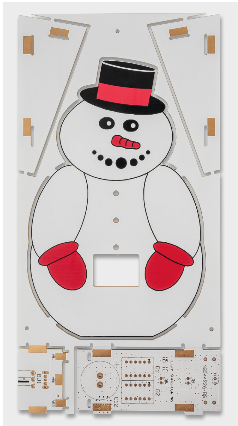
Bild 2: Die entlang der Perforation herausbrechbaren Platinen werden auf einem „Nutzen“ geliefert.
