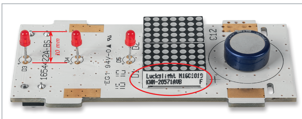
Bild 6: Hier erkennt man die Einbaulage der LEDs, deren Spitzen 10 mm über der Platine liegen müssen, und der LED-Matrix-Anzeigen, die man anhand des seitlichen Aufdrucks wie hier gezeigt einsetzt.
