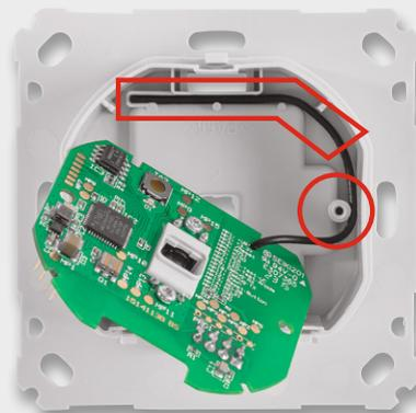
Bild 9: ... danach die Transceiver-Antenne fixiert ...
