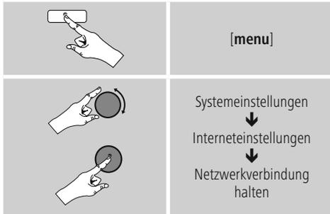
Bei deaktivierter Funktion (**NEIN \***) wird das Netzwerkmodul ausgeschaltet, wenn das Radio aktiv keine Netzwerkverbindung nutzt (z.B. im Standby-Modus / DAB-Empfang). Dadurch kann nach Abschaltung nicht via PC, Smartphone oder Tablet auf das Radio zugegriffen werden. Nutzen Sie also Streaming oder die Steuerung über die App, müssen Sie diesen Menüpunkt aktivieren (**JA \***). Standardgemäß ist diese Funktion deaktiviert.
