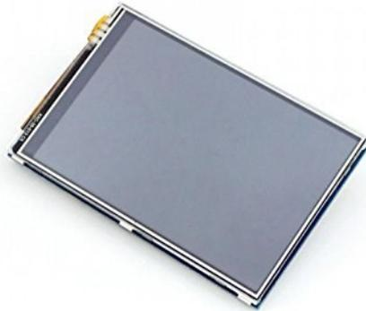
Mit dem 3.5 Zoll großen TFT Touchscreen-Display bauen Sie sich im Handumdrehen einen Mini-Tablet-PC auf der Basis eines Raspberry Pis.
