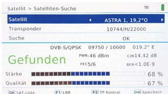
Bild 7: Ist die Antennenschüssel auf den voreingestellten Satelliten ausgerichtet, wird der rote Schriftzug „Suche“ durch den grünen „Gefunden“ ersetzt.
