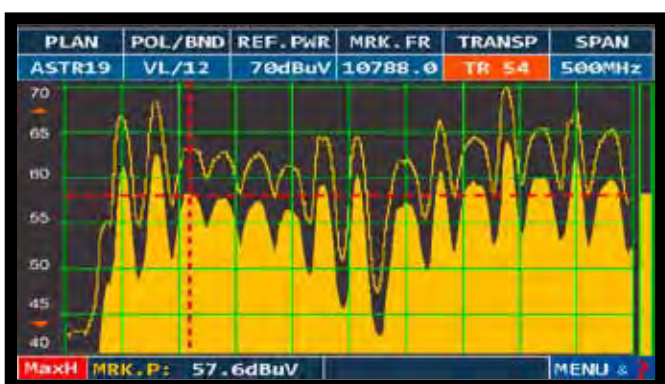
Schnelle Spektrum Analyse mit Spitzenwert-Darstellung
