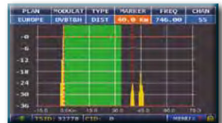
Abb. 3: SCHLECHTER EMPFANG (oder KEIN EMPFANG):* 2 Echos vorhanden, außerhalb des GUARD INTERVAL, aus einer Entfernung von: 1. Echo: 40 Km, 133 \mu s Verzögerung 2. Echo: 45 Km, 150 \mu s Verzögerung
