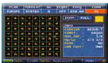
Abb. 4: DVB-T-64Q KONSTELLATION: Die Tabelle rechts zeigt alle verfügbaren
