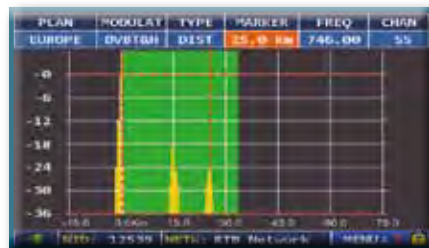
Abb. 2: GUTER EMPFANG:* 2 Echos vorhanden, aber innerhalb des GUARD INTERVAL, aus einer Entfernung von: 1. Echo: 15 Km, 50 \mu s Verzögerung 2. Echo: 24 Km, 83 \mu s Verzögerung
