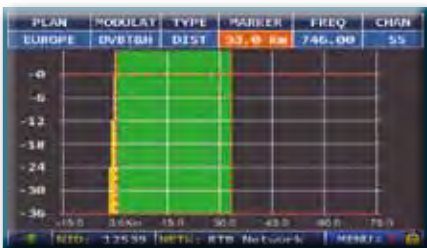
Abb. 1: OPTIMALER EMPFANG:* Kein Echo vorhanden, weder innerhalb, noch ausserhalb der GUARD INTERVAL Maske (grüner Bereich)
