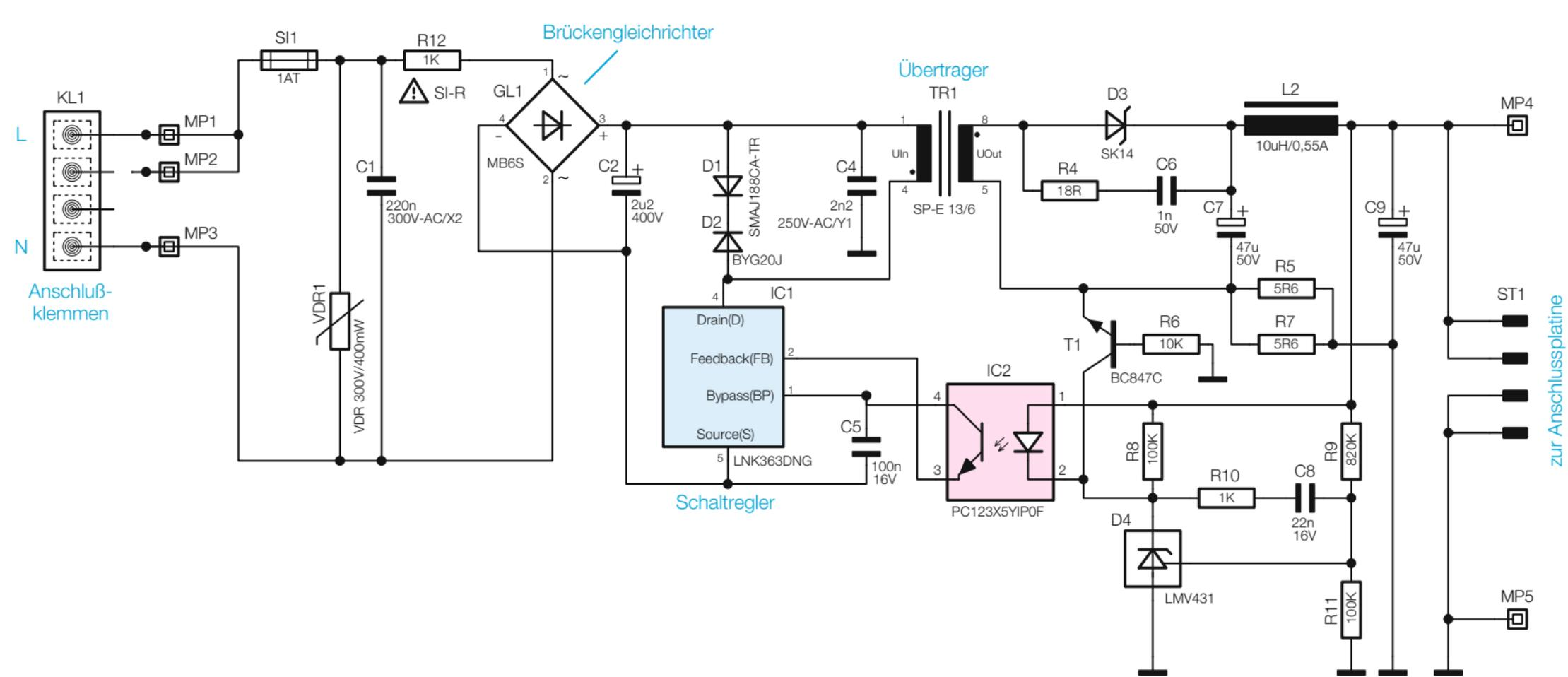
Bild 3: Die Schaltung der Powerplatine 230 Vac zu 12 Vdc
