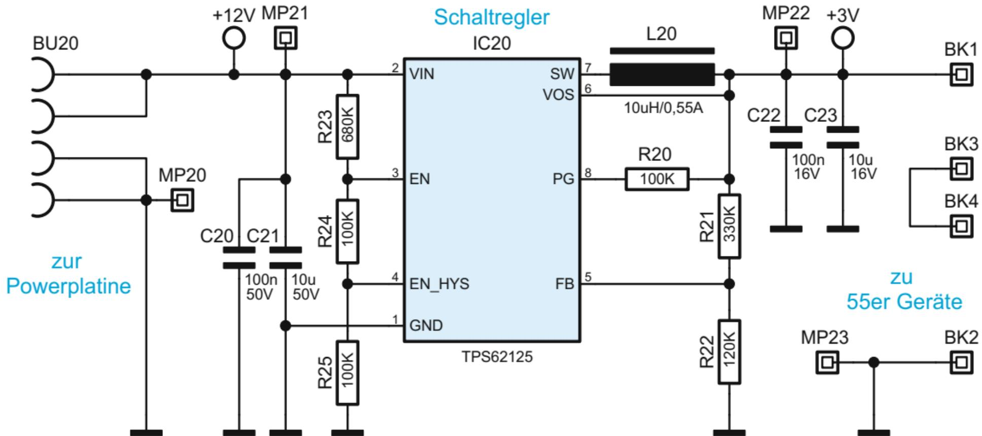
Bild 4: Die Schaltung der Anschlussplatine mit 12 Vdc zu 3 Vdc
