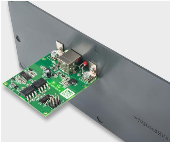
Bild 27: Die Rückwand mit dem USB-Modul
