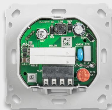
Bild 18: Die eingelegte und aufgesteckte Leistungsplatine
