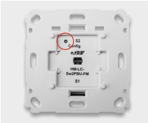
Bild 20: Der Tasterstößel ist auf Leichtgängigkeit zu prüfen.
