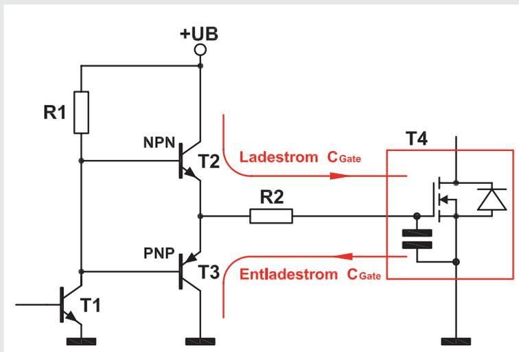
dem Gatekondensator kann sich nun über T3 und R2 entladen. Es gilt zu beachten, dass die Spannung am Gate von T4 nicht ganz der Betriebsspannung entspricht, da hier die Diodespannung (Basis-Emitter) der beiden Emitterfolger abzuziehen ist.
