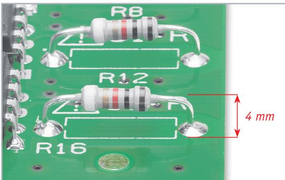
Bild 5: Die Widerstände R4, R8, R12 und R16 müssen in einem Abstand von 4 mm zur Platine montiert werden.
