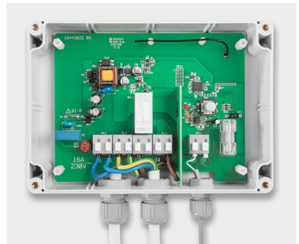
Innenansicht des Homematic Funk-Sollwertgebers
