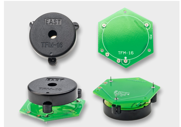
Bild 6: Der Piezo-Signalgeber wird wie hier gezeigt auf der zugehörigen Platine bestückt.
