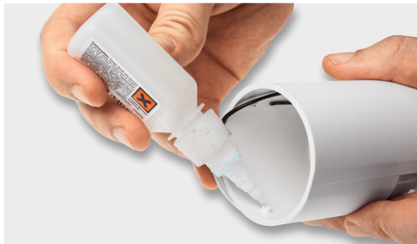
Bild 22: Sichern des Deckels mittels Sekundenkleber ...
