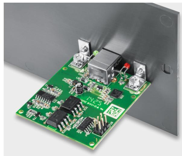
Bild 30: Die Rückwand mit dem USB-Modul
