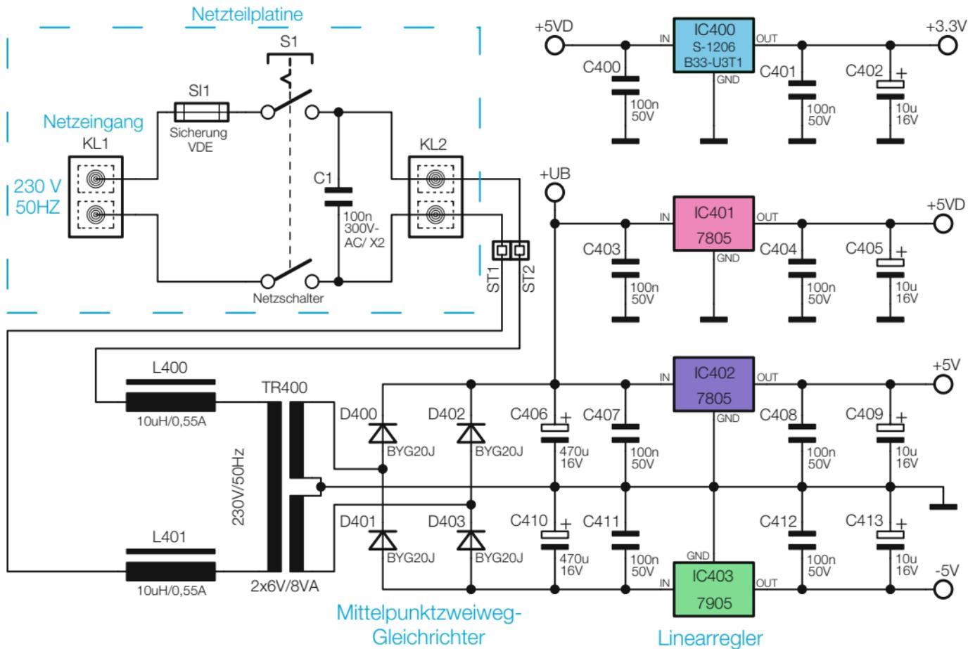
Bild 7: Schaltbild der Spannungsversorgung des FC 8000
