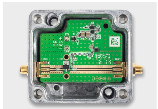
Bild 8: SMA-Buchsen positioniert und auf der Oberseite angeheftet
