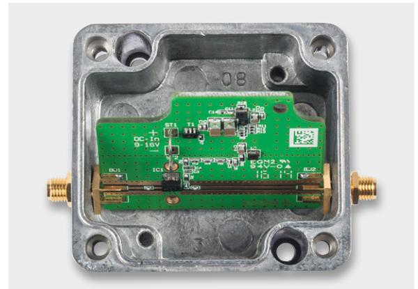
Bild 7: Leiterplatte senkrecht in die SMA-Buchsen eingeschoben
