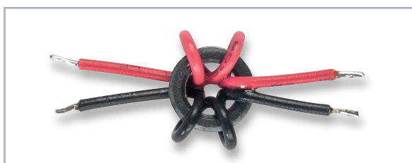
Bild 11: Fertig gewickelte stromkompensierte Ringkerndrossel
