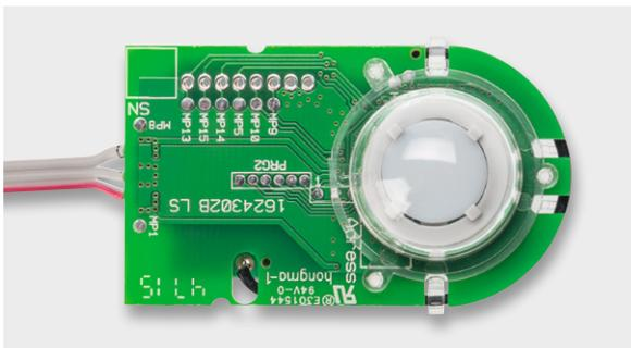
Bild 8: Die auf die Sensorplatine aufgesetzte Linse
