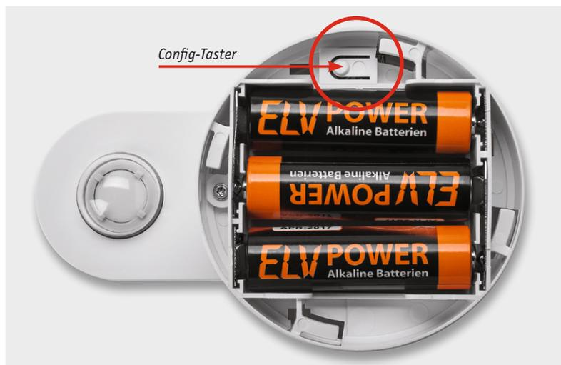
Bild 22: Nach dem Einlegen der Batterien wird die Halterung in das Batteriefach eingerastet ...
