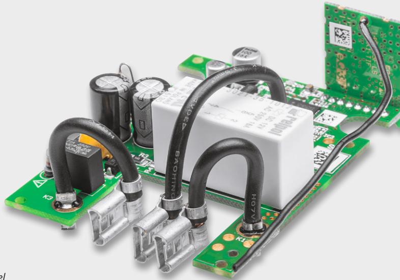
Bild 6: Die zum Anschluss an den Steckdoseneinsatz vorbereiteten Kabel
