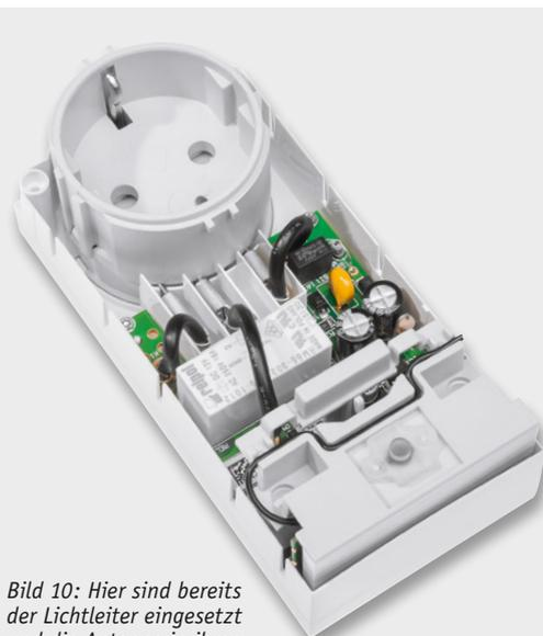
Bild 10: Hier sind bereits der Lichtleiter eingesetzt und die Antenne in ihrer Führung verlegt.
