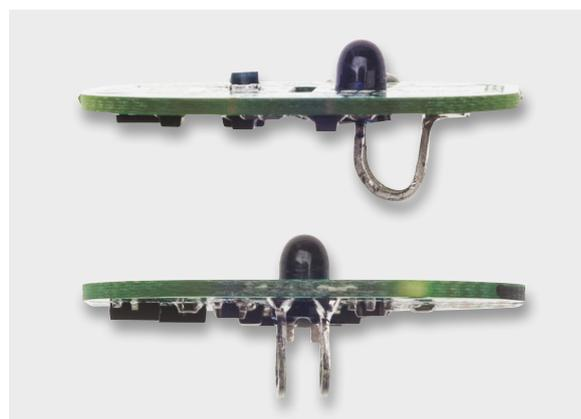
Bild 8: Der Einbau des Fototransistors muss in genau senkrechter Lage zur Platine erfolgen.
