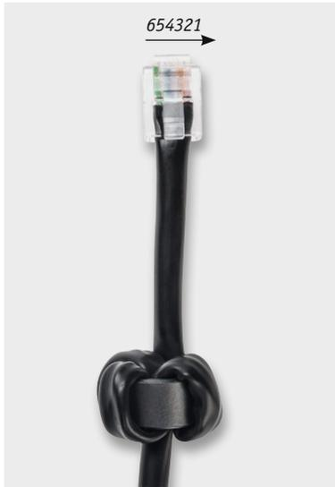
Bild 9: So wird der Ringkern für den Störschutz auf der Leitung angebracht.
