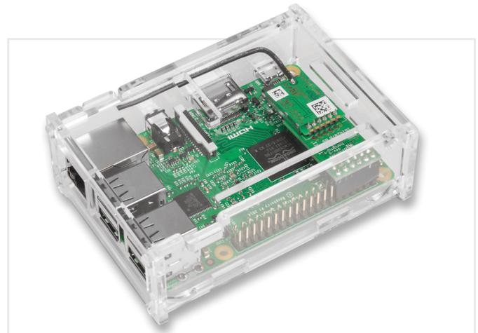
Bild 9: Die fertige Kombination aus Raspberry Pi und Funkmodul sollte in ein passendes Gehäuse eingebaut werden.
