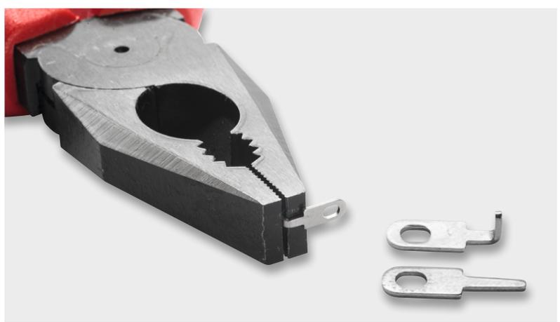
Bild 7: So erfolgt das Biegen der Lötösen.
